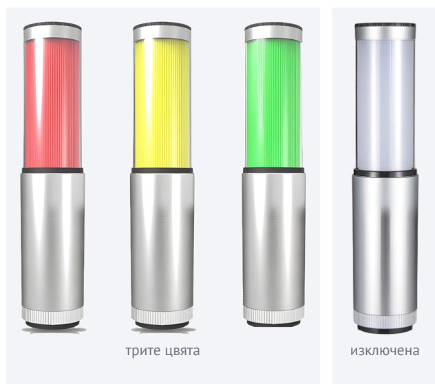
Фиг. 6 – М4С: \varnothing 55 \times 278 mm, три шпилки М4 на \varnothing 40 mm; сгъва се на 90^\circ
